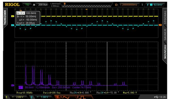
On observe alors l'effet du signal de rapport cyclique variable : la FFT est le produit de Convolution du signal échantillonné avec une PWM (en sinc)
