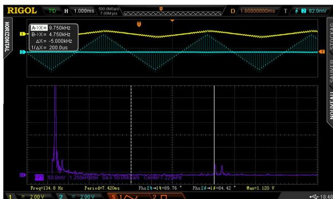
Avant filtrage, la raie à 10kHz est à 0,6V, et après filtrage, elle est logiquement de l'ordre de 60mV : on a bien atténué de -20dB (soit d'un facteur 10).
