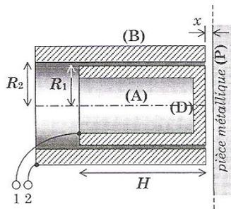
La pièce métallique plane (P) est parallèle à (D) à une distance  $x$ . L'ensemble  $\{(A),(B),(P)\}$  forme une association de trois condensateurs :
