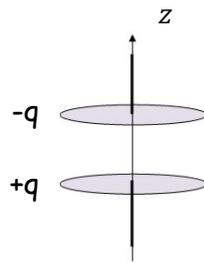
L'électrode supérieure porte une charge  $-q$  et l'électrode inférieure une charge  $+q$ . Ces deux électrodes ont la même géométrie : un disque de rayon  $R$ . On supposera que la charge totale de chaque face est répartie uniformément avec une densité surfacique  $+\sigma$  pour l'électrode inférieure et  $-\sigma$  pour l'électrode supérieure.
