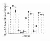
On obtient une série de valeurs  $s_i$  du signal échantillonné. La dernière étape de numérisation consiste à convertir ces tensions sur n bits. Par exemple la conversion d'un signal variant entre -5V et 5V sur 16 bits consiste à convertir ces 10 V sur 65536 niveaux (de -32768 à 32767).
