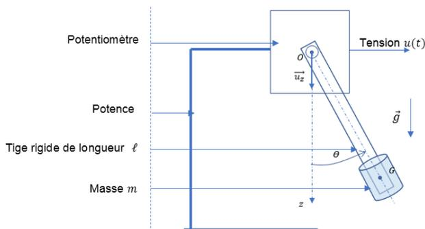
On note  $J$  le moment d'inertie de ce pendule par rapport à son axe de rotation. On suppose la liaison pivot parfaite. On note  $l = OG$ ,  $g$  l'intensité du champ de pesanteur terrestre et  $m$  la masse du pendule. On note  $\theta(t)$  la position angulaire du pendule par rapport à la verticale. L'oscillation du pendule génère une tension  $u(t)$  proportionnelle à  $\theta(t)$
