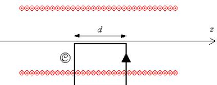
$R_1$  et d'un conducteur de rayon  $R_2$ . Entre les deux conducteurs, le milieu est assimilé à du vide. Avec  $h \gg R_2 > R_1$  on pourra négliger les effets de bord. Le cylindre intérieur est siège d'un courant surfacique d'intensité  $I$  s'établissant sur sa surface latérale  $I = j_s \times 2\pi R_1$ . Le câble alimente une résistance de charge  $R_c$  ce qui permet au courant d'intensité  $I$  de circuler sur la surface  $2\pi R_2 h$  conducteur extérieur.
