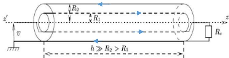
6) Donner l'expression du vecteur densité de courant surfacique  $\vec{j}_s$  caractérisant le courant sur le conducteur extérieur de rayon  $R_2$ .
