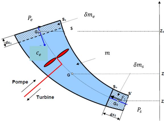
Le système fermé étudié est délimité entre les sections  $S_1$  et  $S_2$  à l'instant  $t$  et entre les sections  $S$  et  $S'$  à l'instant  $t + dt$ . Nous supposons qu'un travail indiqué  $\delta W_i$  peut être échangé avec une machine (en revanche aucun transfert thermique avec l'extérieur ne sera transmis :  $Q = 0$ ).
