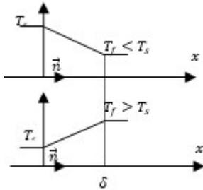
Pour traduire ce transfert thermique on utilise la loi de Fourier en supposant le profil ci-contre :  $\vec{j} = \frac{\lambda_f(T_s - T_f)}{\delta} \vec{n} = h(T_s - T_f)\vec{n}$  où  $\vec{n}$  est un vecteur unitaire orienté vers la normale sortante du solide et  $h = \frac{\lambda_f}{\delta}$  est appelé coefficient de transfert conducto-convectif typiquement  $h \approx 100W.m^{-2}.K^{-1}$
