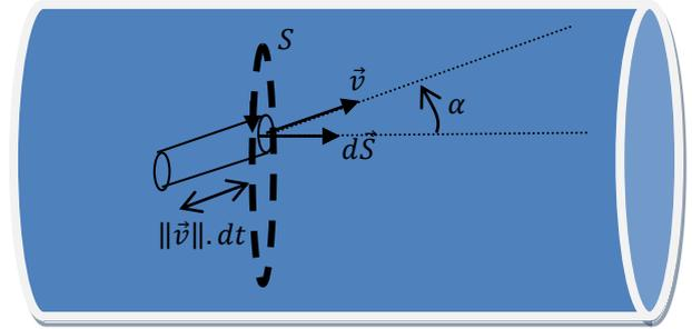
Donc  $\delta^2 V = ||\vec{v}|| \cos \alpha dS dt$  et le volume qui va traverser  $dS$  pendant  $dt$  est  $\delta V = \iint_S ||\vec{v}|| \cos \alpha dS dt$
