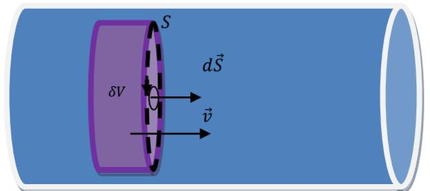
Supposons que l'écoulement soit uniforme et axial alors  $\delta V = \|\vec{v}\| dt S$ . Le débit est alors donné par
