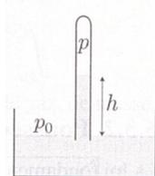
Ce tube est retourné dans une cuve contenant également du mercure, en contact avec l'air atmosphérique, à la pression ordinaire  $P_0 = 1,013 \cdot 10^5 Pa$ . La colonne de mercure dans le tube s'abaisse, jusqu'à atteindre une hauteur  $h$ .
