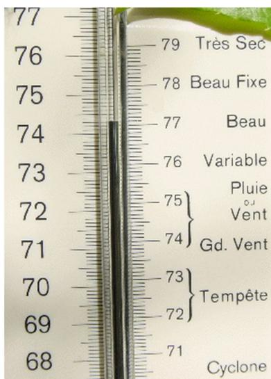
La création du vide d'air dans l'éprouvette va permettre de mettre en évidence la pression atmosphérique par création d'une différence de pression. La colonne de mercure est alors soumise à son poids et à la force de pression atmosphérique (non compensée).
