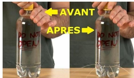
En fermant la bouteille, l'eau arrête de s'écouler car il y a création d'une dépression.
