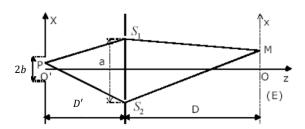
La source est une fente de largeur 2b et de hauteur  $h\gg 2b$  (diffraction dans le plan de (xOz) uniquement). Chaque point de la source émet une amplitude de vibration identique.
