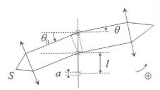
On éclaire un réseau avec un pinceau de lumière parallèle de longueur d'onde  $\lambda_0=500nm$  (dans le vide) et on observe la figure d'interférence à l'infinimontage dit de Fraunhofer). Les ondes diffractées par chaque motif interférent du fait de leur cohérence.
