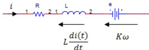
Lorsque le transistor  $T$  est bloqué alors aucun courant ne traverse le moteur et la tension à ses bornes est  $e = K\omega$  où  $K$  est la constante du moteur et  $\omega$  sa vitesse de rotation. Parallèlement, d'un point de vue mécanique, il n'y
