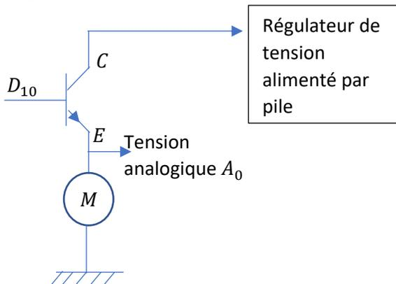
On mesure la tension analogique  $A_0$  aux bornes du moteur.
